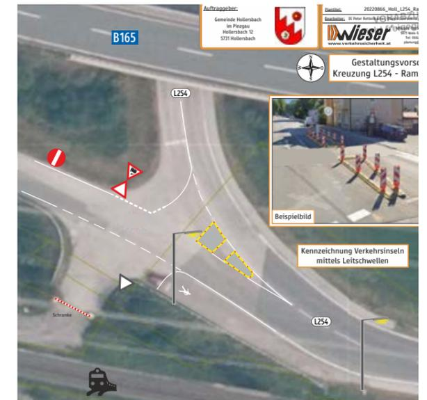
Nach der Salzachbrücke, beim **Übergang zum Badeseeparkplatz**, wird die **Querung ebenfalls verkürzt** und die Fahrbahn in einem Ausmaß verengt, dass das Tempo der vorbeifahrenden LKWs und PKWs angepasst werden muss, der Fluss des Verkehrs aber nicht behindert wird.
